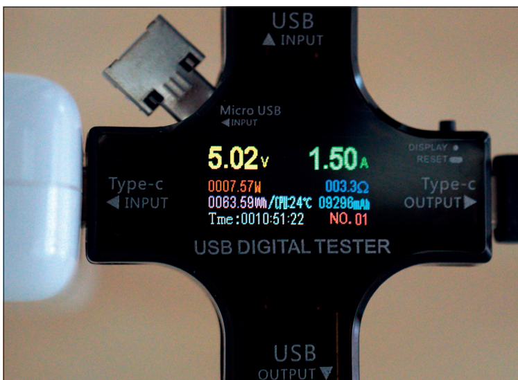
Abspielen von 12K BRAW mit externer SSD braucht beim Mac nur 7,5 Watt.
